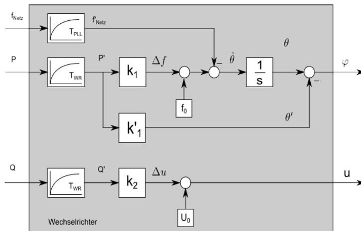
Abbildung 1: Inverter Control Model
